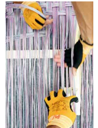
Tissage de fils Twiggy en cours sur la structure d'un meuble.
